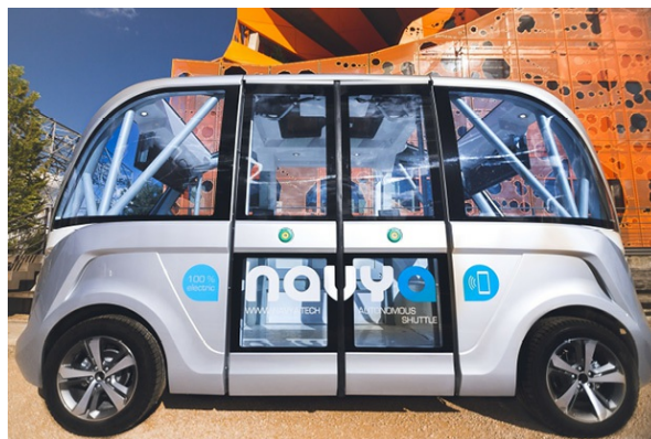
图14.31 Naveya公司推出的Arma行驶速度20km/h 自动驾驶车，可以载15人，行驶速度45km/h
